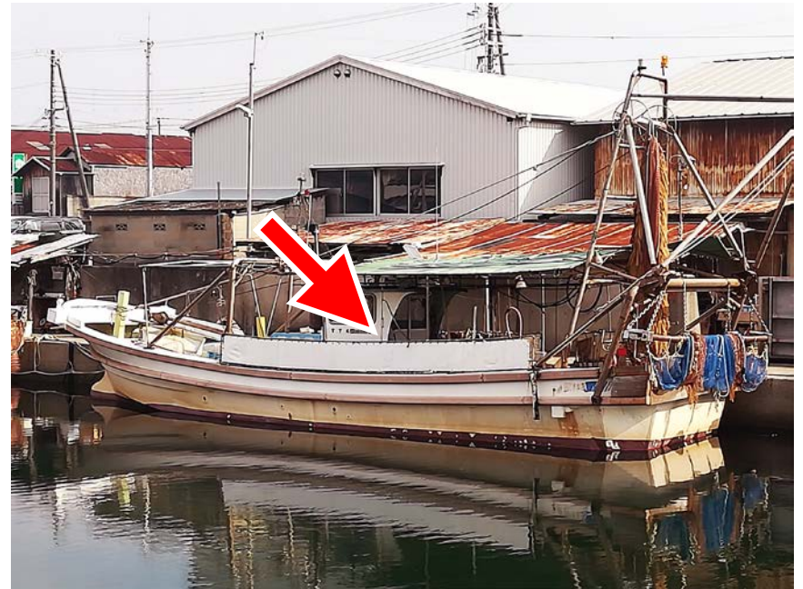
手すりの設置例②
